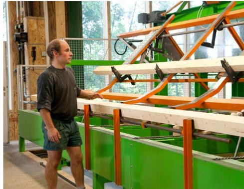
2. Anschließend werden Holzfehler ausgekappt und die optimierten Hölzer auf die gewünschte Länge zusammengezinkt.
