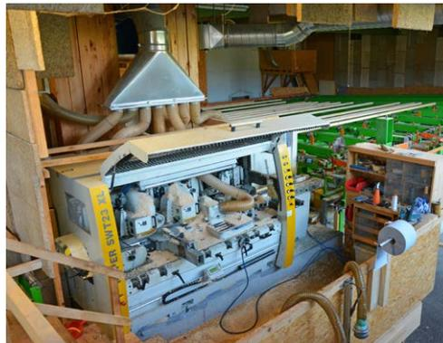
4. Bei Weiterverarbeitung der Lamellen zum DiagonalDübelholz® wird in der Hobelmaschine noch die Wellenprofilierung seitlich eingefräst.
