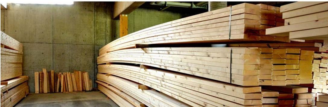
Ausgangsprodukt in unserer Produktionslinie sind Holzbretter geschnitten im Rift- oder Halbriftnschnitt. Diese werden von uns beginnend von der Keilzinkung, über die Verdübelung zum DD-Element, weiter zur CNC-Abbandanlage sowie Handabbund, bis hin zur Montage durch unser eingespieltes Team verarbeitet.
