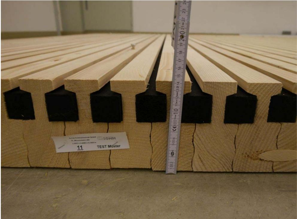
Abbildung B.1. Detailansicht Elementquerschnitt mit eingelegten PET-Faserdämmstreifen.
