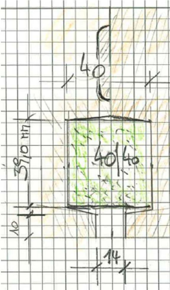
Abbildung C.1. Geometrie von Ausfräsung, Schlitz und Absorbereinlage.
