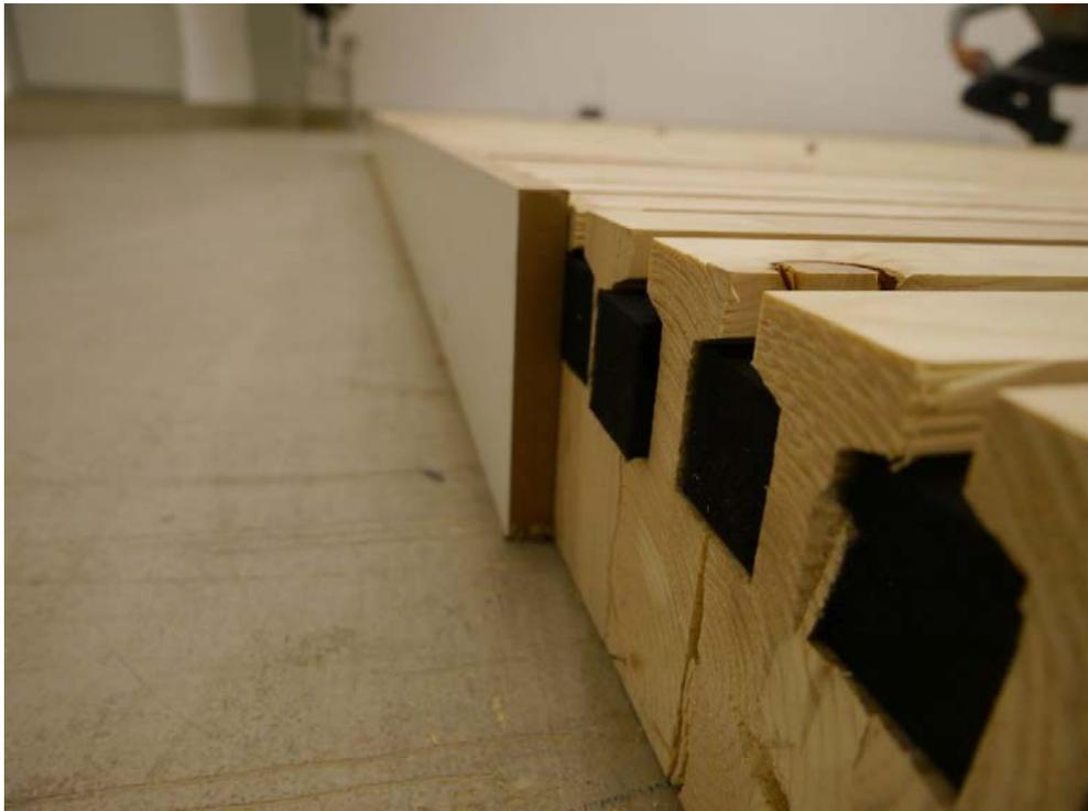
Abbildung B.3. Prüfaufbau während der Montage im Hallraum: Element auf dem Hallraumboden, Umfassungsrahmen teilweise erstellt.
